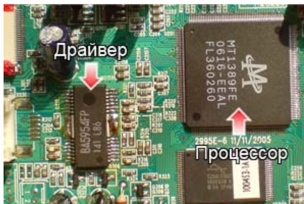
Рисунок 12 – Розташування драйвера керування приводом на платі програвача DVD
