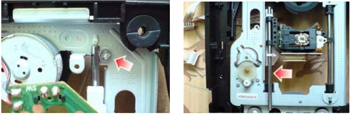
Рисунок 7 – Зняття оптичного лазерного блоку
