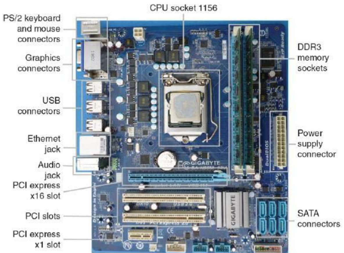
Рис. 10. Зовнішній вигляд системної плати Gygabyte GA-H55M-S2V
